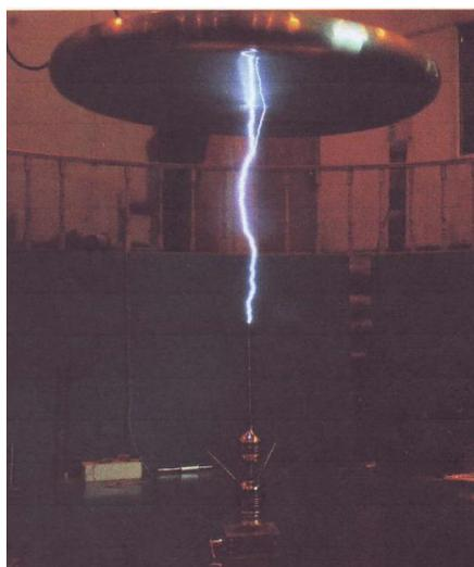
圖 9 ESEAT 成功捕獲模擬雷擊
