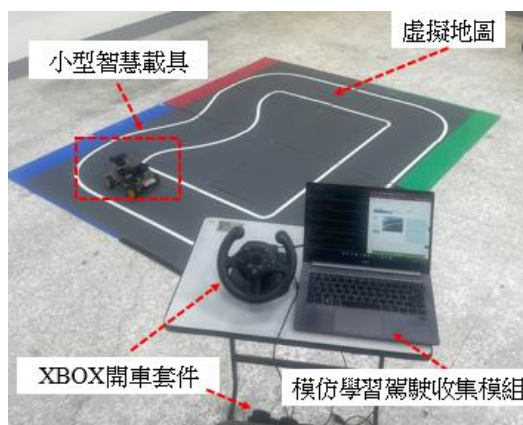
圖 2 透過模仿學習方式由專家示範來訓練的系統架設照片
