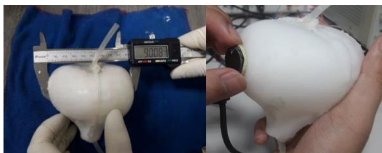
圖 14 游標卡尺量測橫向最大直徑 TD_{(rule)} (左) 與探頭量測假體擺放位置 (右)
