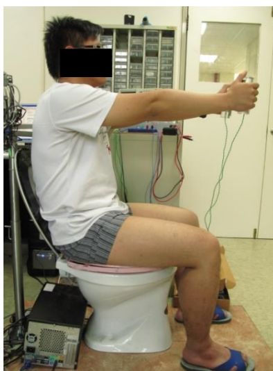
圖13 手握電極把及馬桶座之量測照片
