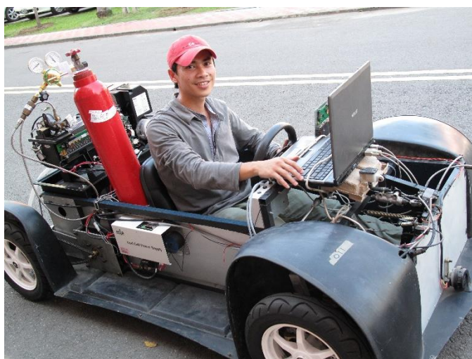
圖 1 改裝後之燃料電池/電池混合動力車
