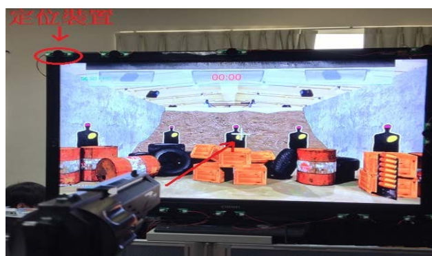
圖 20 系統整合後的實際射擊畫面圖及精確的光槍指向裝置 (具校正功能)
