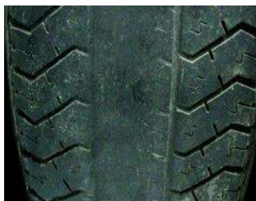
圖 1 胎壓過高胎面中央磨耗圖
