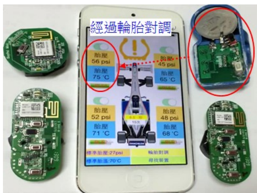
圖 34 APP 接收 BLE 監測模組圖
