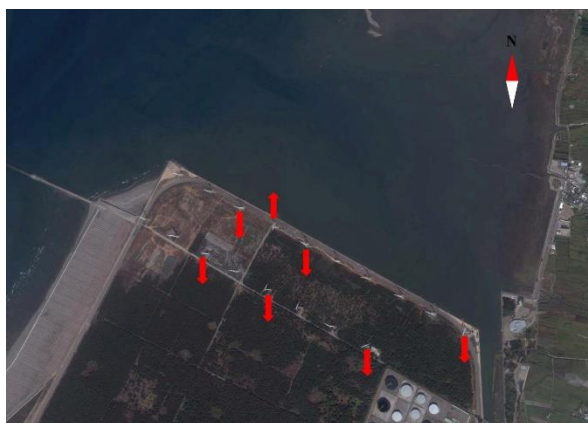
圖2 台中港區風力機組配置與倒塌方向示意圖
