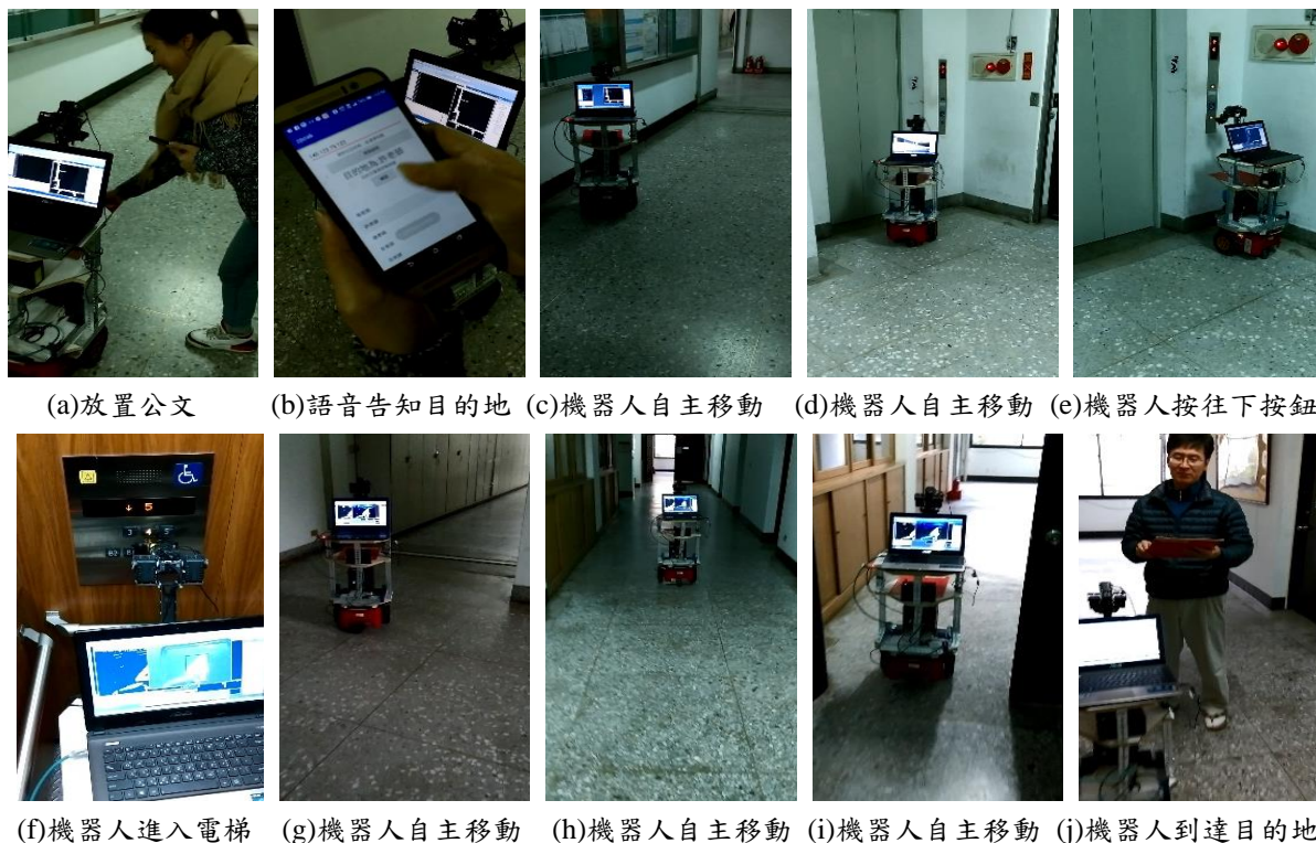
圖 24 跨樓層文件傳遞機器人系統之整體實驗截圖
